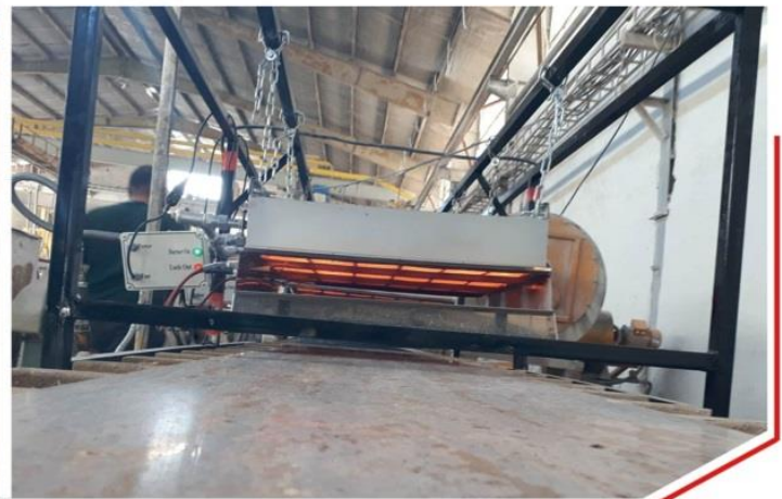
سیستم گرمایش تابشی سرامیکی در فرآوری سنگ تایل
