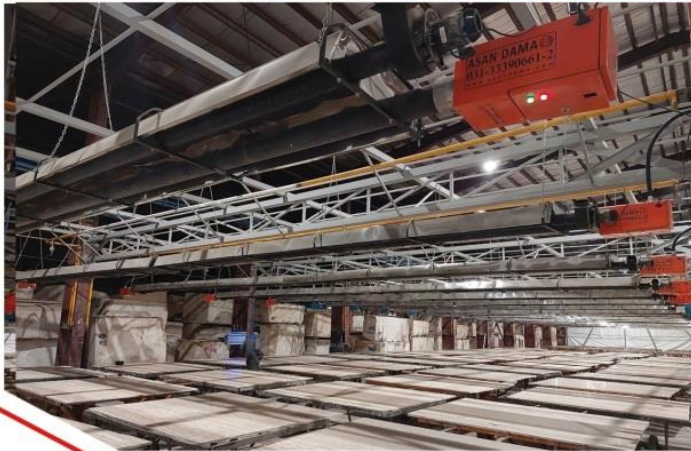
سیستم گرمایش تابشی لوله ای در فرآوری سنگ اسلب
