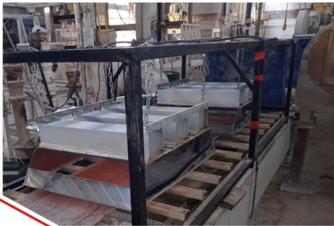
سیستم گرمایش تابشی سرامیکی در فرآوری سنگ تایل
