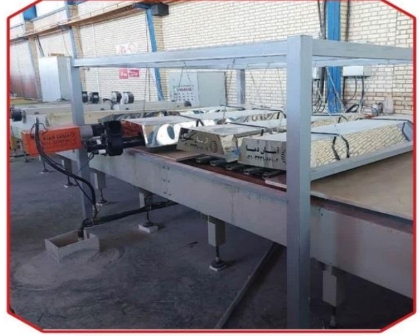
گرمایش تابشی لوله ای در تامین گرمایش خط اسلب
